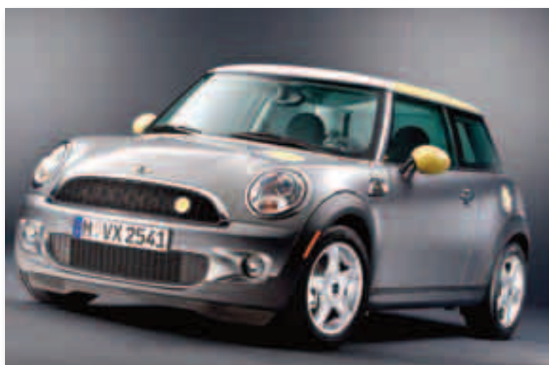
El Mini E tiene un motor eléctrico de 204 CV que permite una autonomía de 250 km y que se puede recargar en un enchufe
