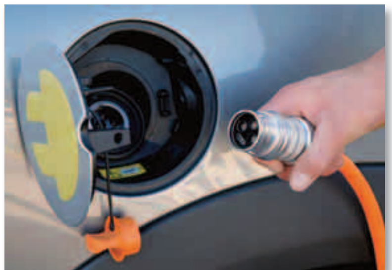
Una toma trifásica con una tensión de 400 voltios es el 'cargador universal' para todos los vehículos en todos los países
