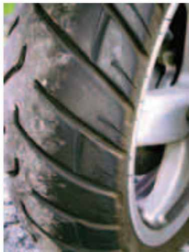
La profundidad del dibujo del neumático debe ser de al menos 1,6 milímetros
