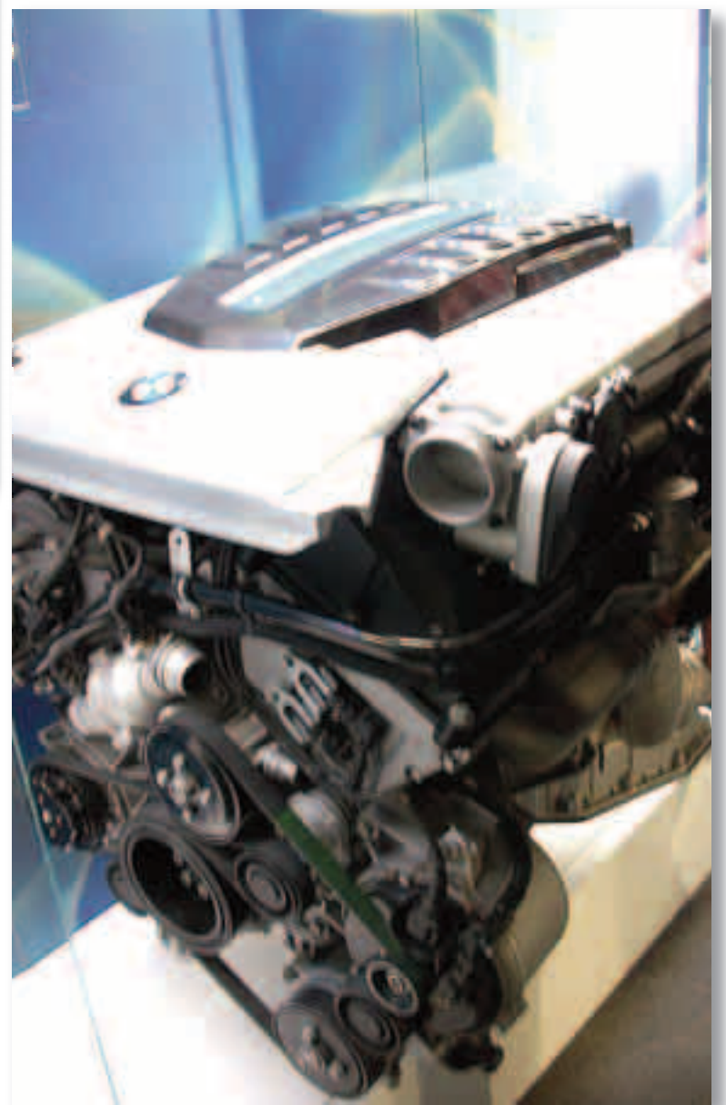
Motor de hidrógeno diseñado por BMW
