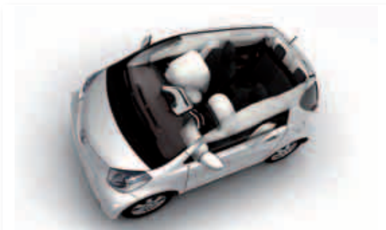
Los airbags (frontales, laterales, de cortina...) envuelven el habitáculo del iQ
