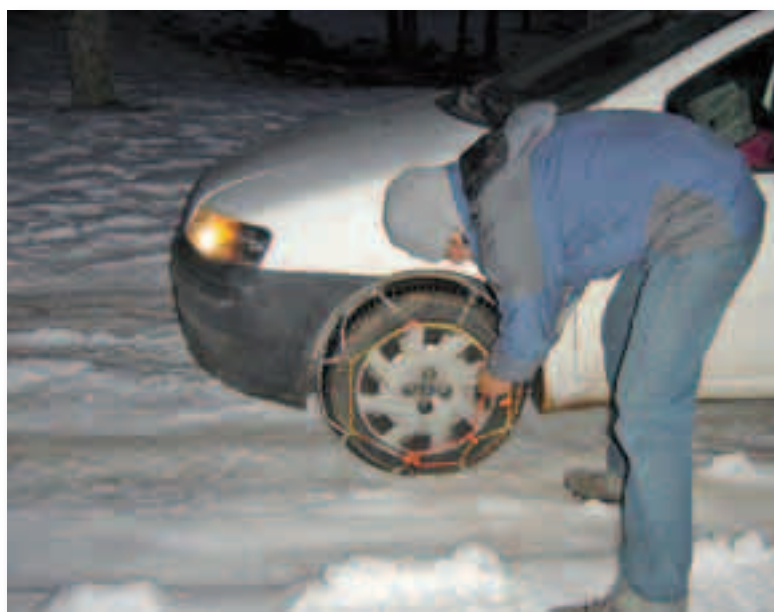
Las cadenas sólo pueden instalarse en el eje motriz del vehículo
