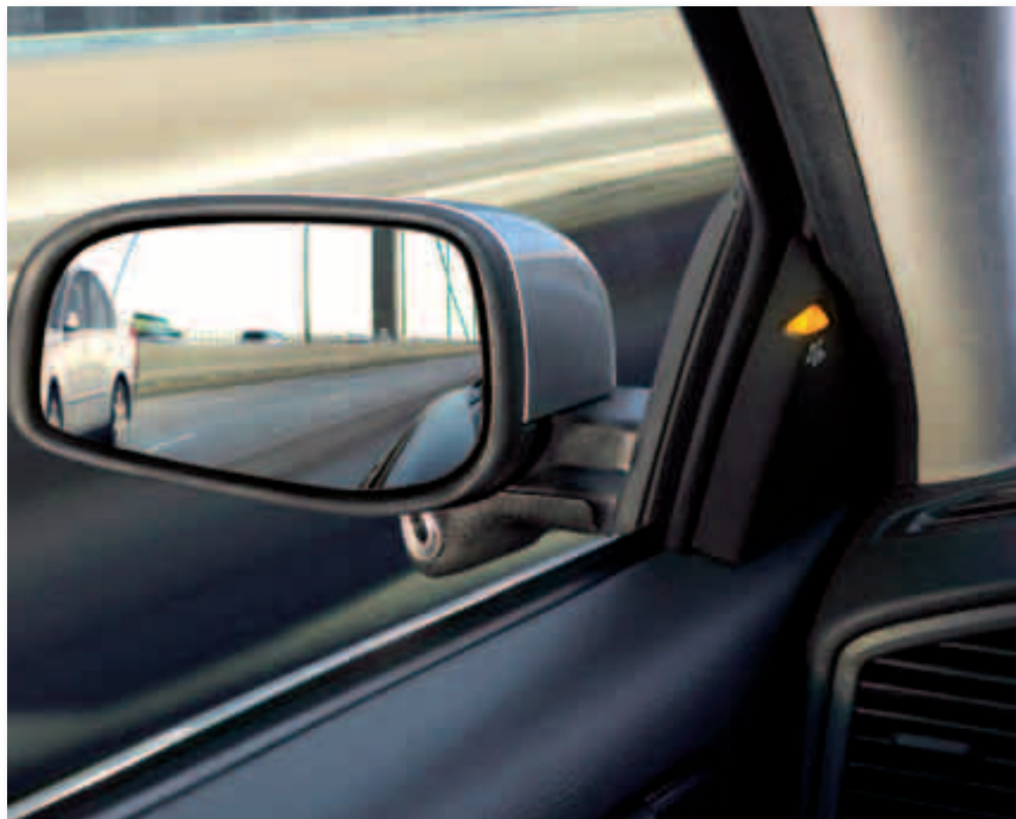
El piloto naranja avisa al conductor cuando la cámara instalada bajo el retrovisor detecta un vehículo en nuestro ángulo muerto
