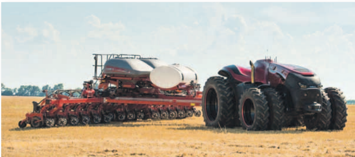
El tractor autónomo pesa 11 toneladas y puede ser muy efectivo en grandes explanadas
