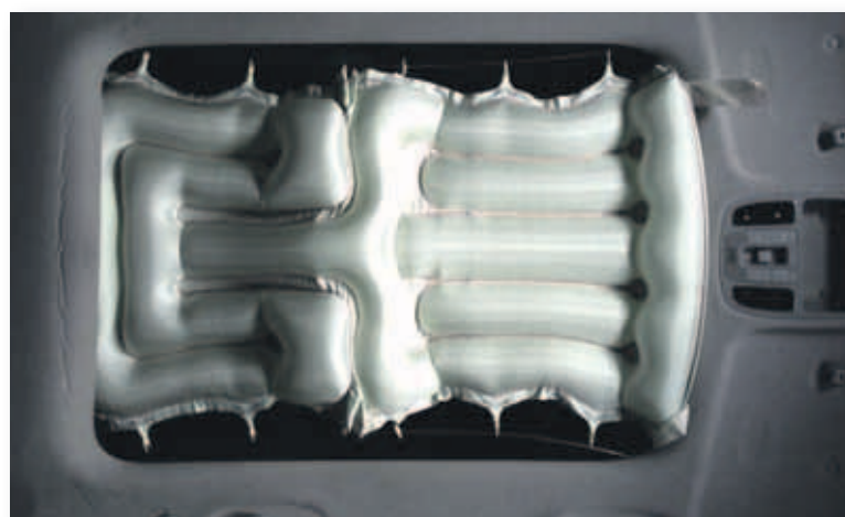
El airbag se oculta entre las dos láminas del cristal y es capaz de desplegarse en sólo 0,8 segundos
