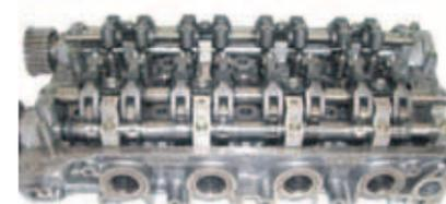
La culata es la parte superior del motor, aunque en ocasiones también se le denomina tapa de cilindros. Con ella se cierran los cilindros en su parte superior, y se alojan las válvulas de admisión y escape, las bujías (en motores de gasolina), el árbol de levas, los conductos de admisión de aire y combustible y los conductos de escape.
