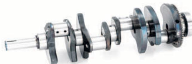
El cigüeñal es algo así como el eje maestro del motor. Se trata de la pieza que soporta las fuerzas y presiones que provocan las válvulas al realizar la combustión. El cigüeñal empuja a los pistones que transmiten la energía al cigüeñal a través de las bielas, convirtiendo los movimientos alternativos en fuerza circular.
