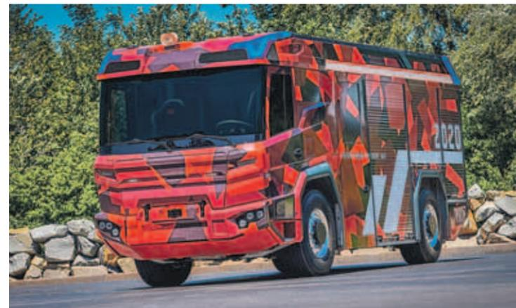
El RT se puede cargar tanto con corriente alterna como continua, dependiendo de la infraestructura disponible, sin tener que utilizar un dispositivo específico, con una toma industrial de corriente estándar.
